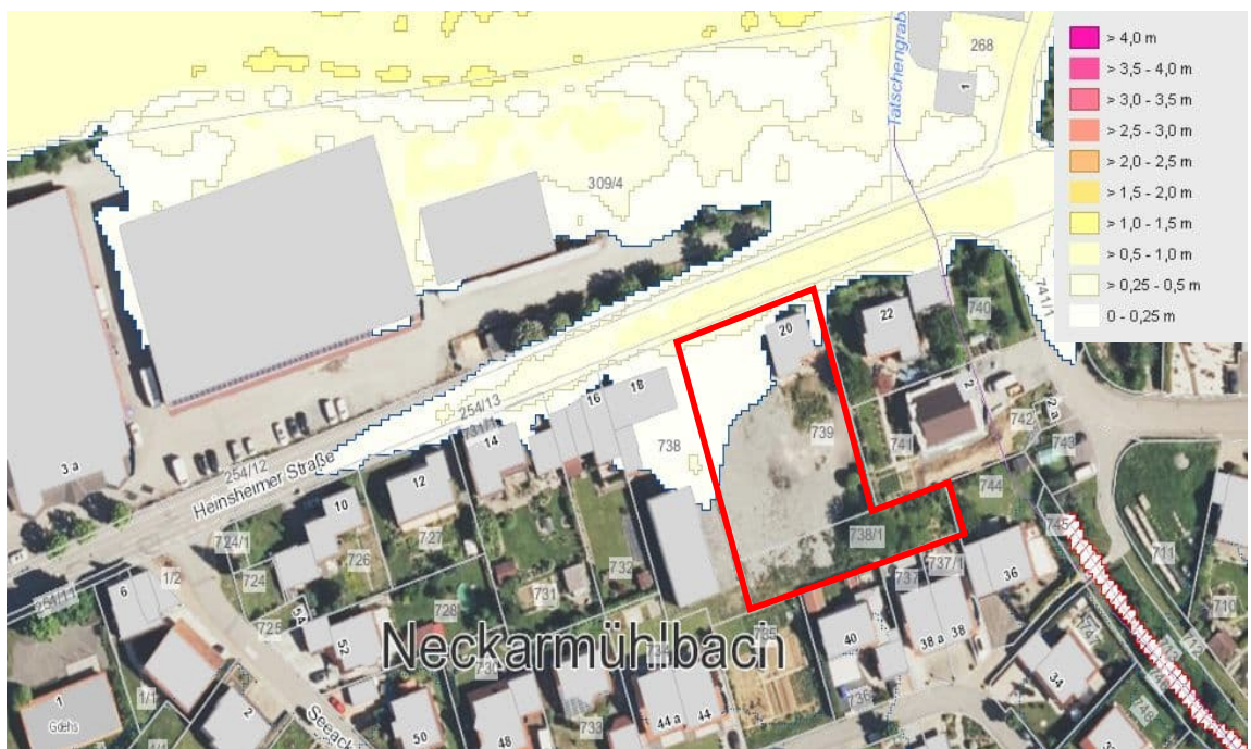
Abb. 5: Überflutungstiefen bei HQ 100 (Quelle: LUBW, November 2022)
